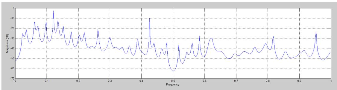
(d) Quadrature Phase Shift Keying Modulated Signal
